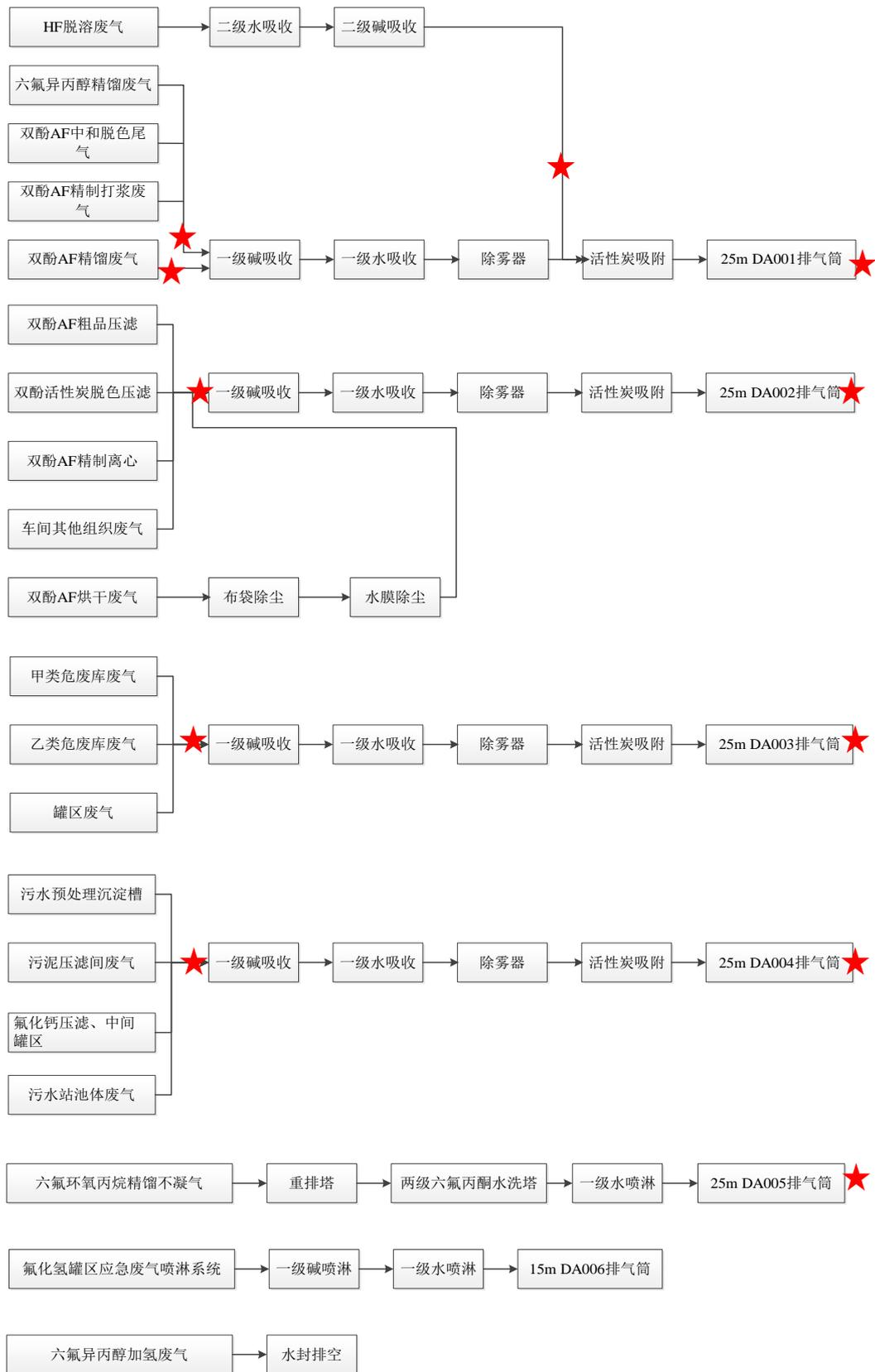
图 4.1-2 本次已建成部分涉及废气处理工艺流程图（星号为检测采样点）
